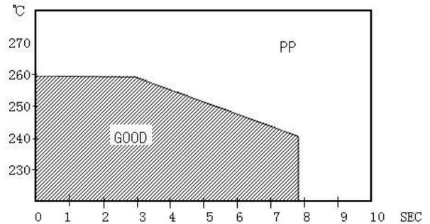
注：薄膜电容器不适合回流焊焊接，否则产品会因热收缩导致性能问题。
